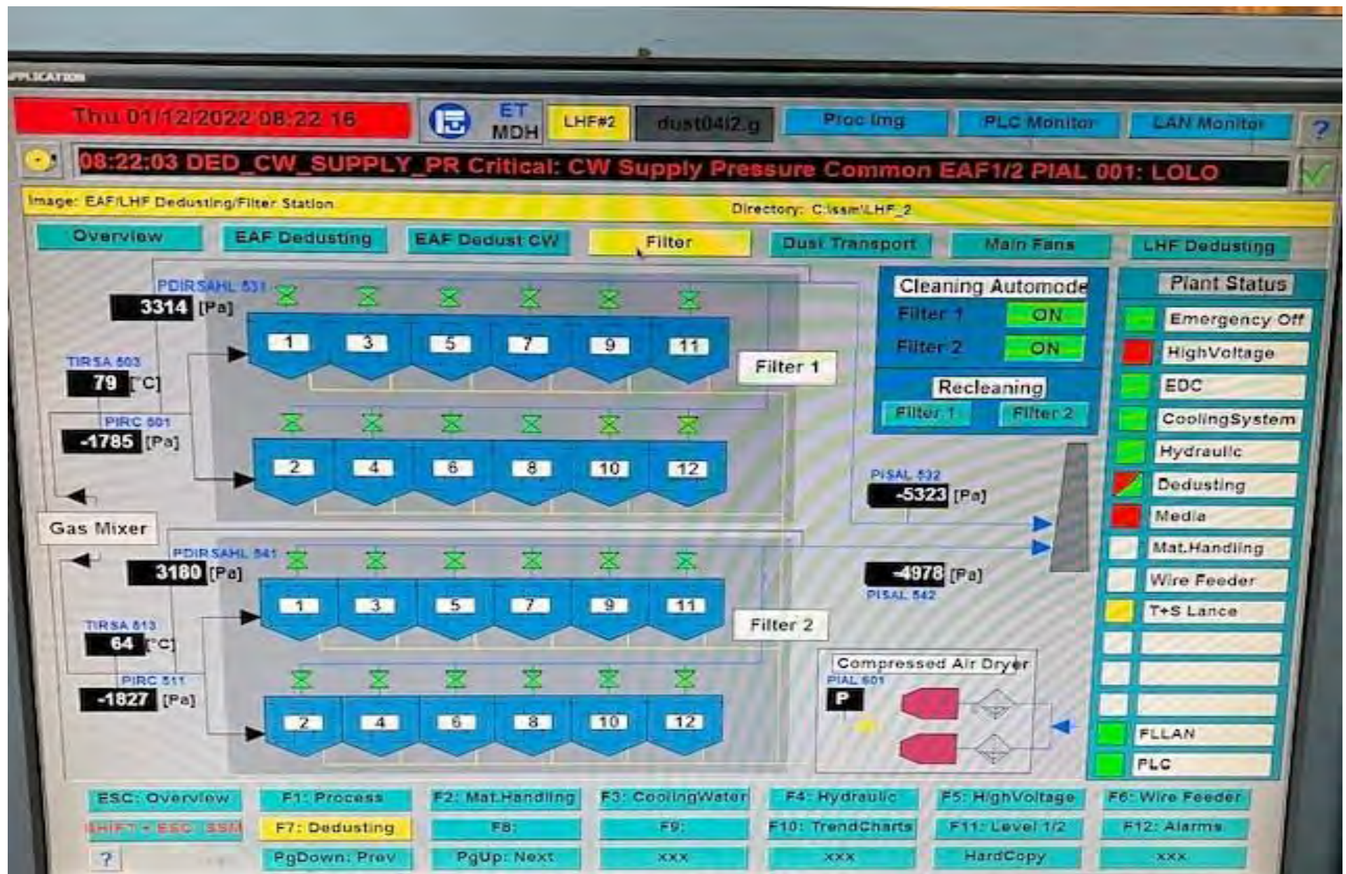
Diagram แสดงการทำงานของ Bag Filter House
